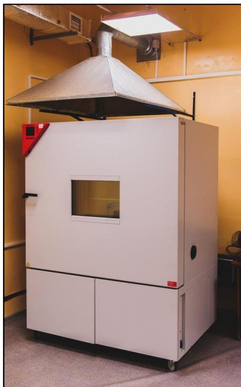
Камера MKT720 BINDER, служит для моделирования температуры окружающей среды для сложных условий в области низких температур
