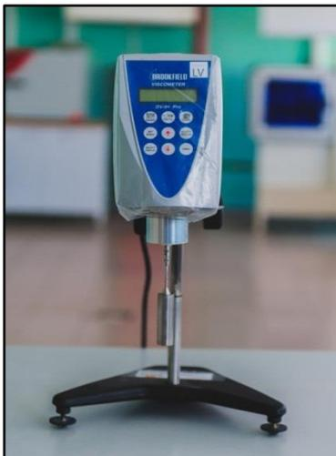
Цифровой вискозиметр Brookfield, предназначен для определения динамической вязкости жидкости
