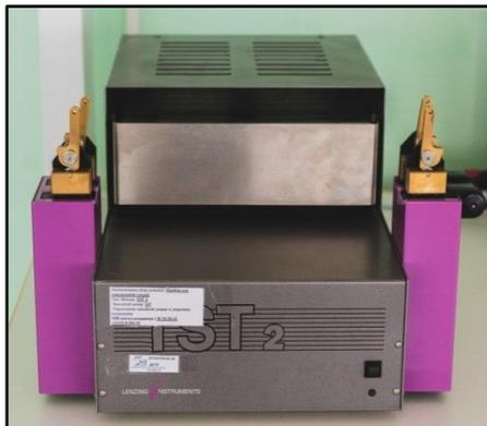
Прибор TST -2, предназначен для определения линейной усадки вытянутых нитей
